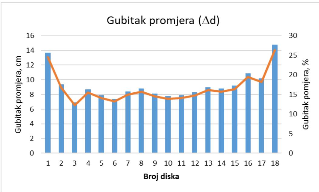
Grafikon 2. Gubici promjera diskova tanjurače uslijed trošenja
