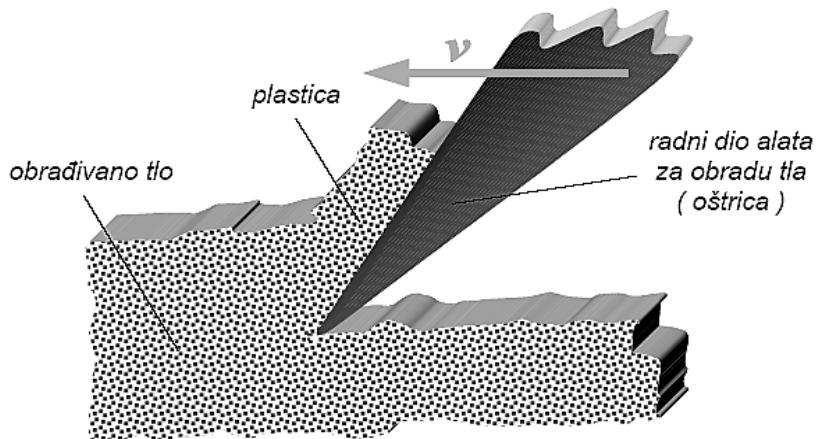
Slika 4. Shema tribosustava alata za obradu tla
