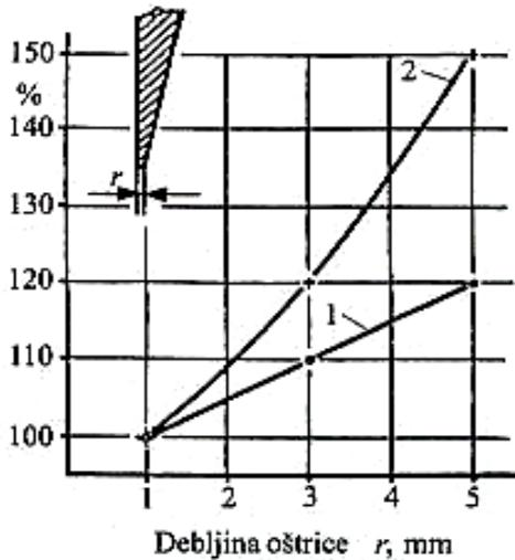
Slika 3. Utjecaj debljine oštice lemeša na potrošnju goriva (1) i vučni otpor (2)
