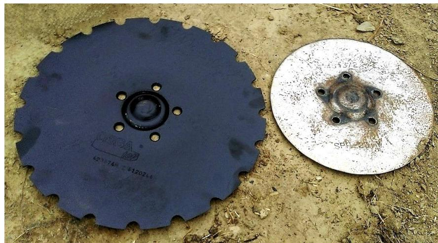
Slika 36. Usporedba novog i istrošenog diska tanjurače
