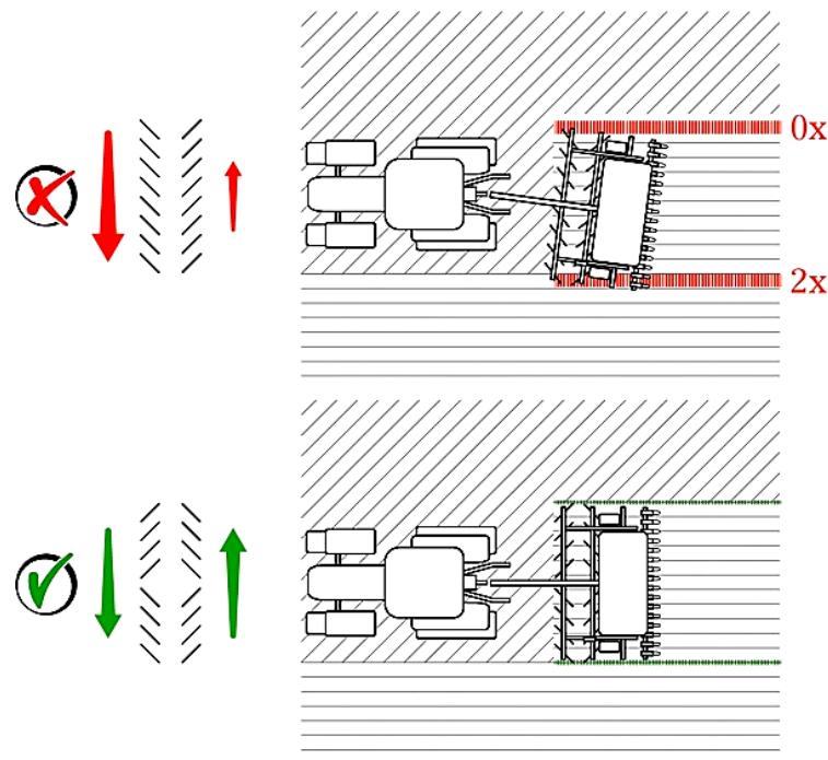
Slika 23. Shema rada sijačice s postavljenim x-diskovima
