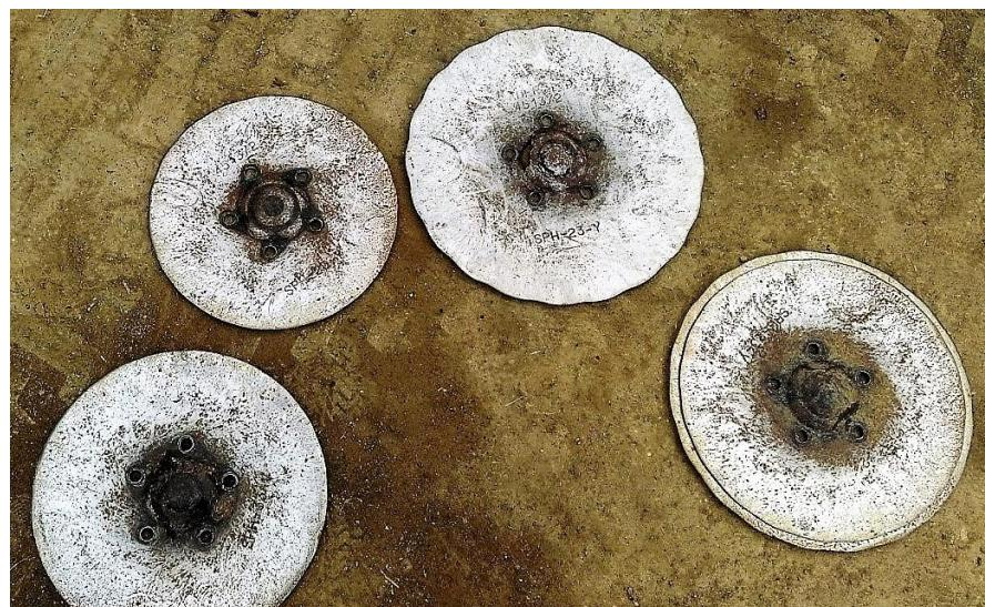
Slika 34. Demontirani istrošeni diskovi tanjurače
