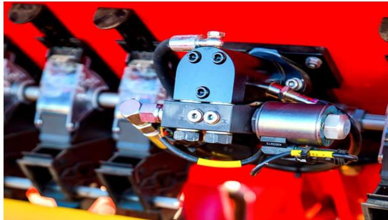
Slika 22. Sustav za hidrauličko mjerjenje na sijačici Rapid 400C
