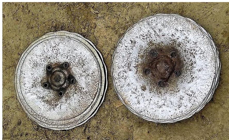
Slika 35. Usporedba istrošenosti diskova tanjurače
