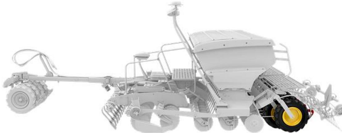
Slika 28. Četvrta zona rada sijačice Rapid 400C
