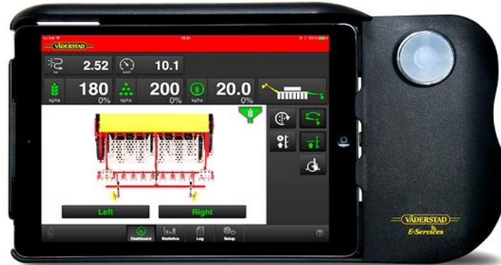
Slika 24. Sustav za upravljanje sjetvom „Väderstad E-Control“
