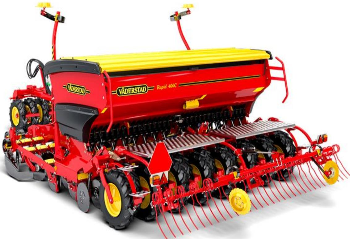
Slika 16. Pneumatska sijačica „Väderstad Rapid 400C“
