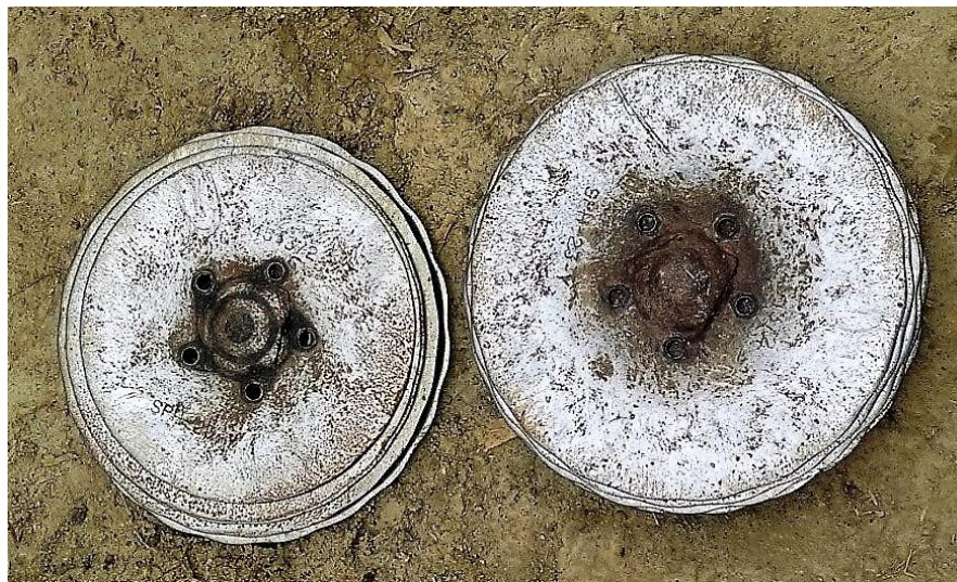
Slika 35. Usporedba istrošenosti diskova tanjurače
