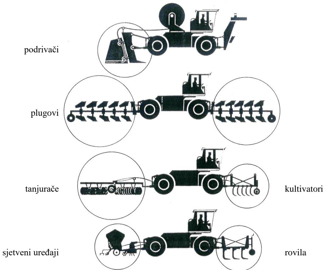
Slika 1. Poljoprivredna mehanizacija za obradu tla izložena trošenju
