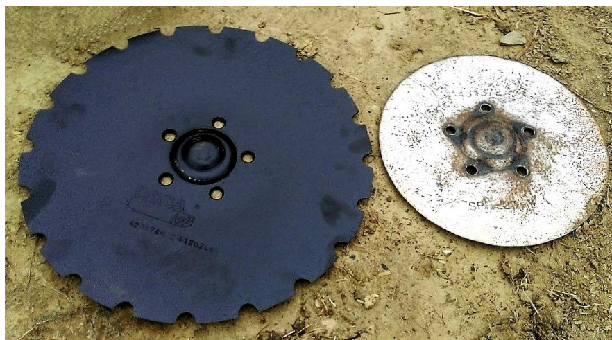
Slika 36. Usporedba novog i istrošenog diska tanjurače
