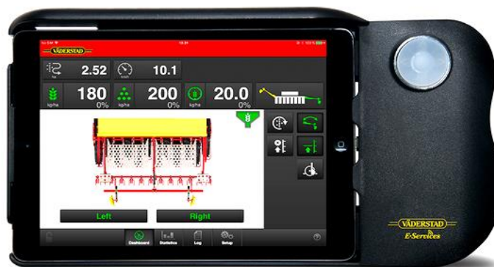
Slika 24. Sustav za upravljanje sjetvom „Väderstad E-Control“
