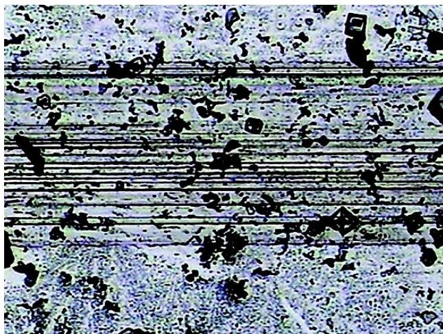
Slika 8. Trošenje tribokorozijom
