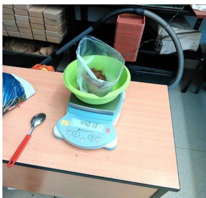
Slika 13. Vaganje uzorka prije prosijavanja (Izvor: Vlastita fotografija)
