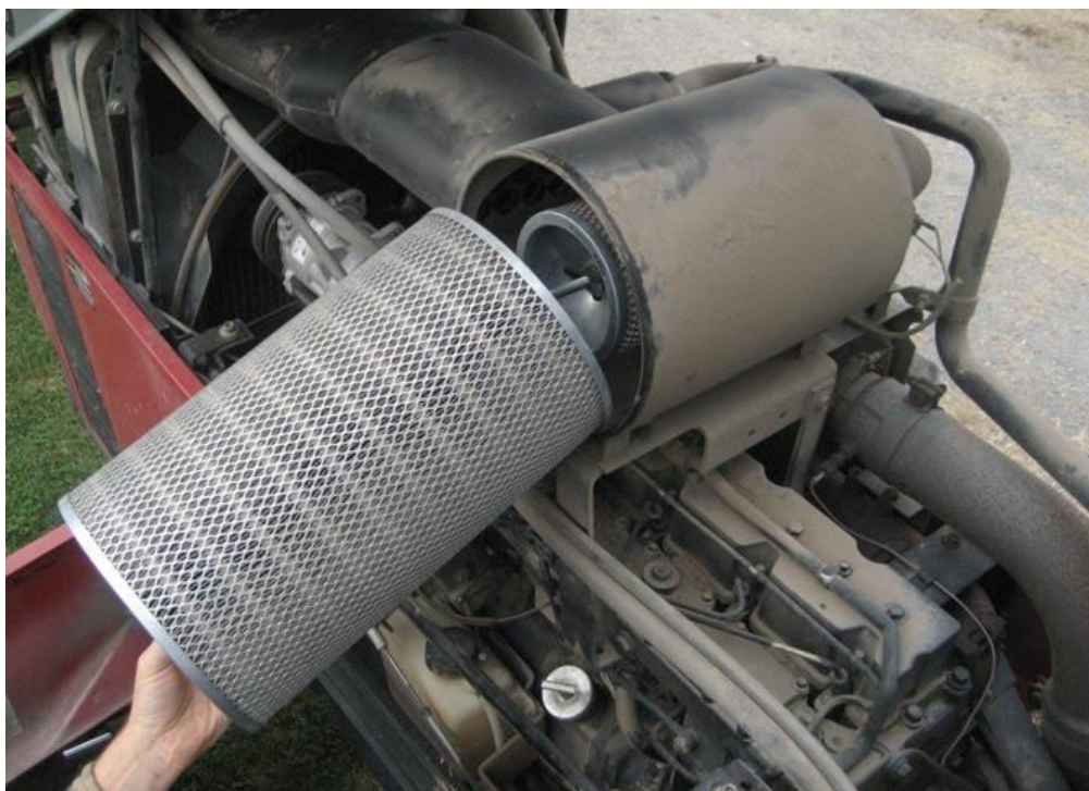
Slika 5: Suhi pročistač zraka (Izvor: Raić D.)
