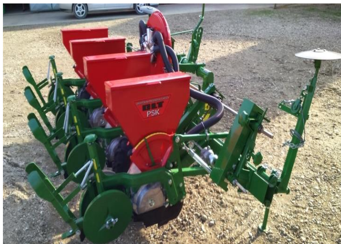
Slika 6. Pneumatska sijačica PSK-4 (Izvor: Foto original L. Kurkutović)
