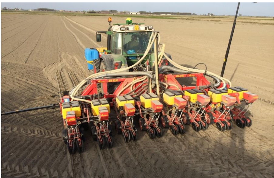
Slika 1. MaterMacc Twin Row-2 sijačica u radu (Izvor: Foto original L. Kurkutović)
