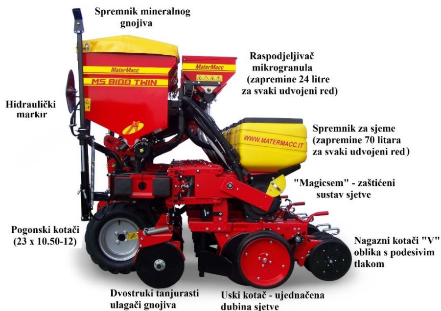
Slika 2. Glavni sustavi sijačice MaterMacc Twin Row-2 (Izvor: http://www.matermacc.it )
