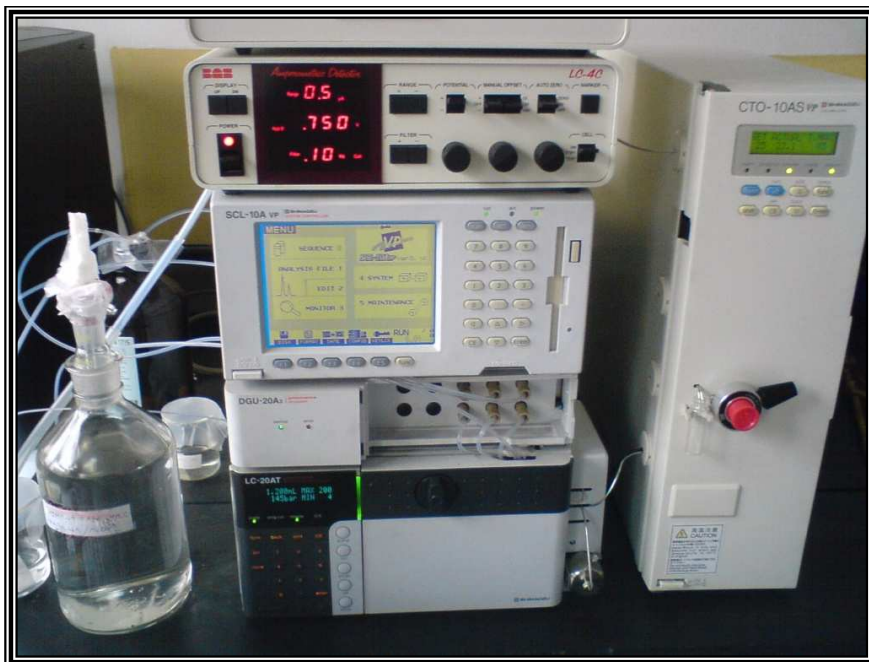
Slika 18. Instrument visokotlačne tekućinske kromatografije
