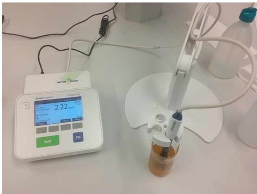
Slika 7. Mjerenje električne provodljivosti uređajem Metler Toledo
