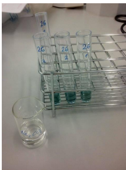
Slika 15. Dodavanje \text{Na}_2\text{CO}_3 u epruvete
