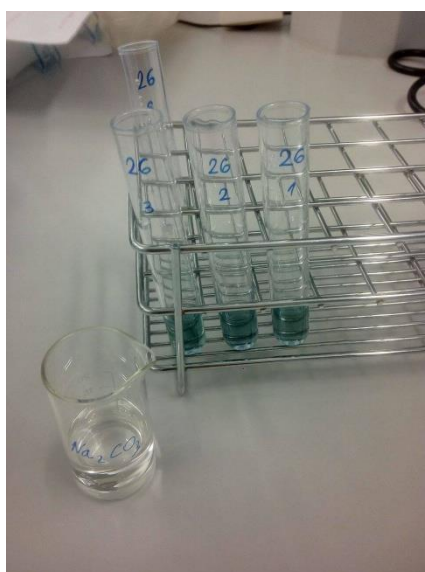
Slika 15. Dodavanje \text{Na}_2\text{CO}_3 u epruvete
