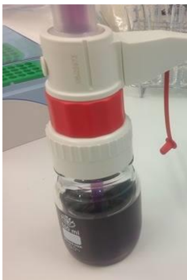
Slika 10. Dozator s otopinom DPPH i 96%-tnog etanola
