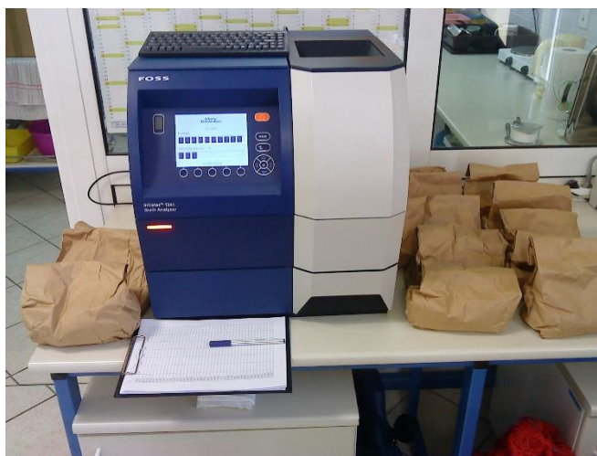
Slika 7. Infratec Grain Analizator, uređaj za određivanje kvalitete zrna pšenice (izvor: Iljkić, D.)
