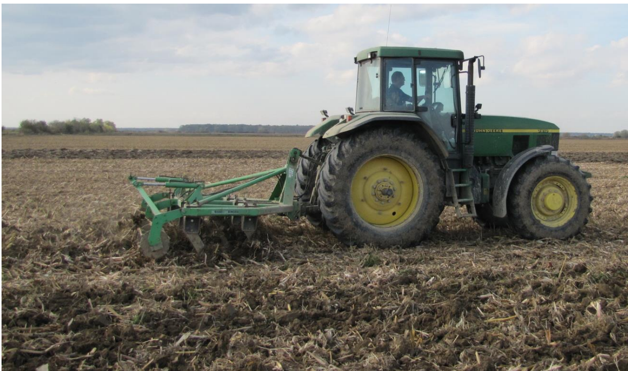
Slika 1. Konvencionalna obrada tla oranjem (izvor: Jug, D.)
