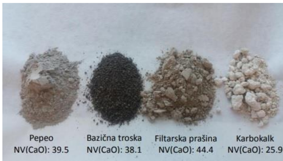
Slika 10. Kalcizacijski materijali i njihove neutralizacijske vrijednosti (Izvor: Ivezić i sur., 2018.)
