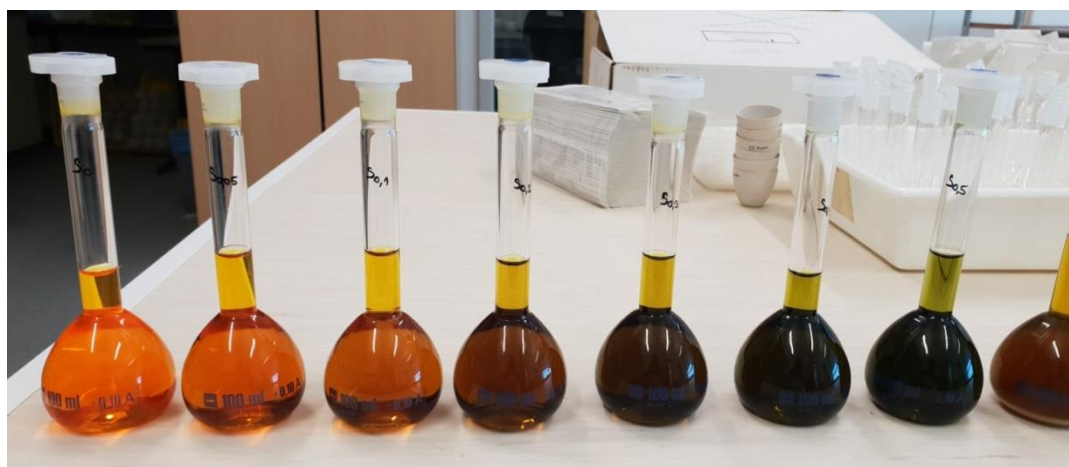
Slika 7. Promućkani standardi i uzorci u odmjernim tikvicama od 100 ml (Izvor: autor)
