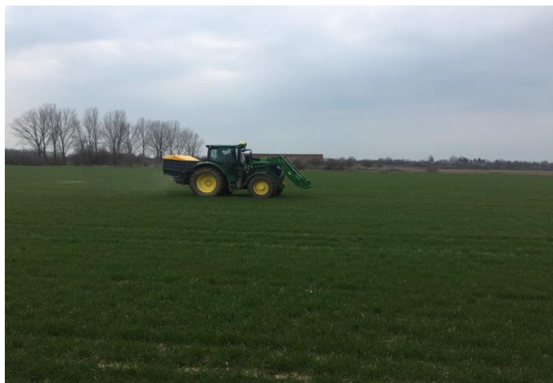
Slika 3. Prihrana pšenice s traktorom John Deere 6145 R i rasipačem Bogballe 2000 (izvor: Tokić, M.)
