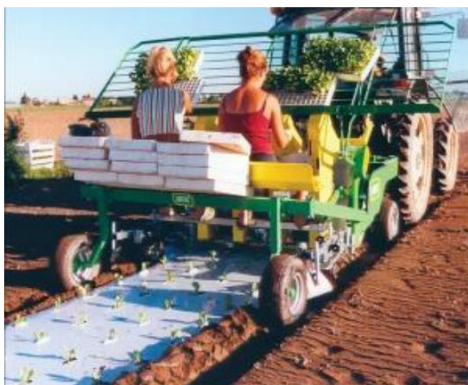
Slika 10. Mehanizirana sadnja salate na foliji (lijevo) i ručna sadnja salate (desno) (izvor:
