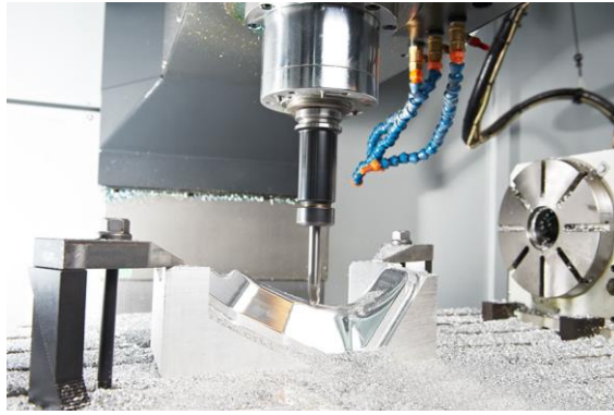
Slika 4. Postupak glodanja aluminijske legure CNC metodom ( http://www.ironal.sk/ )
