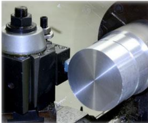
Slika. 3. Tokarenje aluminijevske legure ( http://lesmillerdesigns.com/machining.html )
