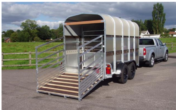
Slika 24. Prikolica za prijevoz konja izrađena od aluminijske legure ( http://www.batesontrailers.com/shop/livestock-trailers/48hb-livestock-trailers-cattle-cow-sheep-pig-calf/ )
