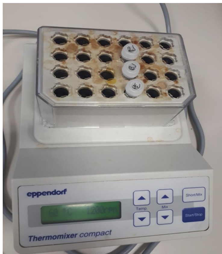
Slika 7. Uzorci stavljeni na hidrolizu pri 60° C (Foto original: Jelena Musić)
