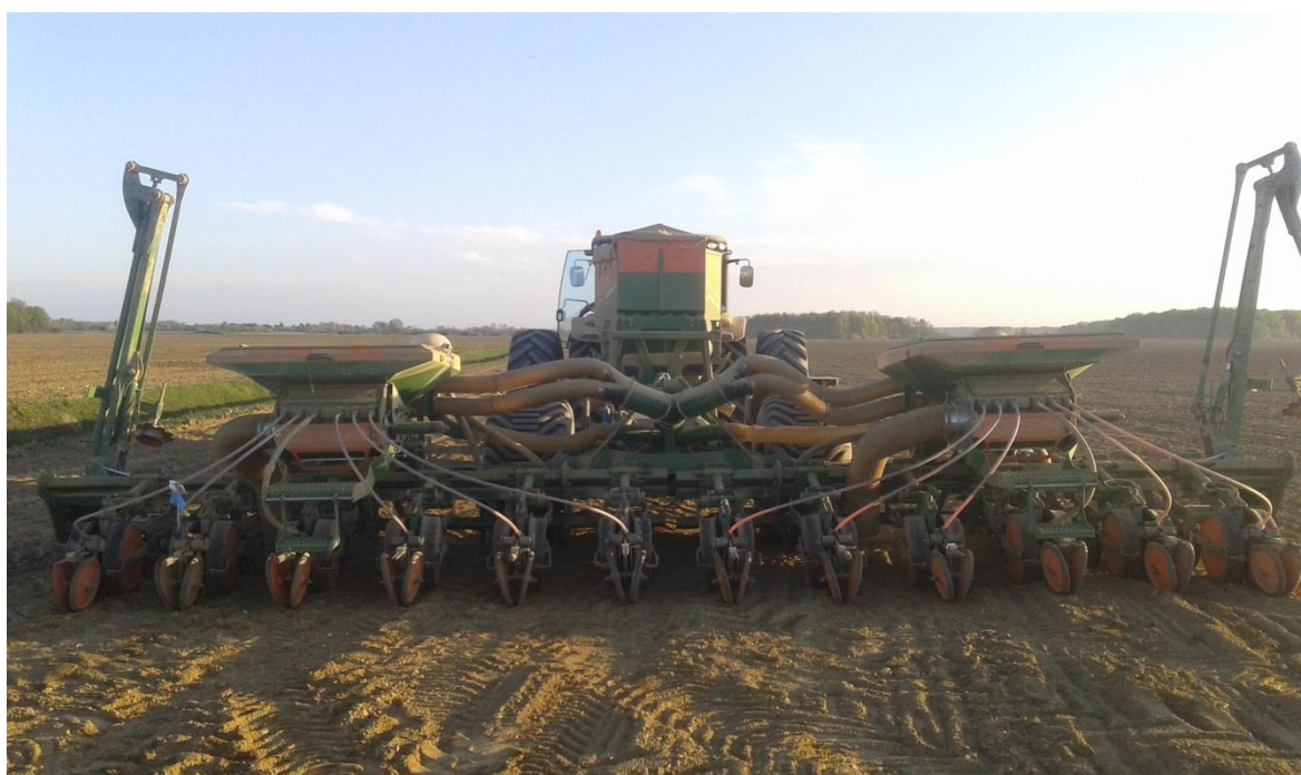
Slika 23 Sijačica „Amazone EDX 9000 TC“ – sprovodne cijevi (Izvor: Vlastita fotografija)
