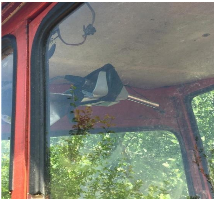
Slika 8. Zvučna sonda postavljena na desnoj strani traktora
