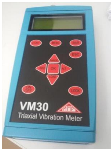
Slika 9. Uređaj za mjerenje vibracija MMF VM30 (vlastita fotografija)
