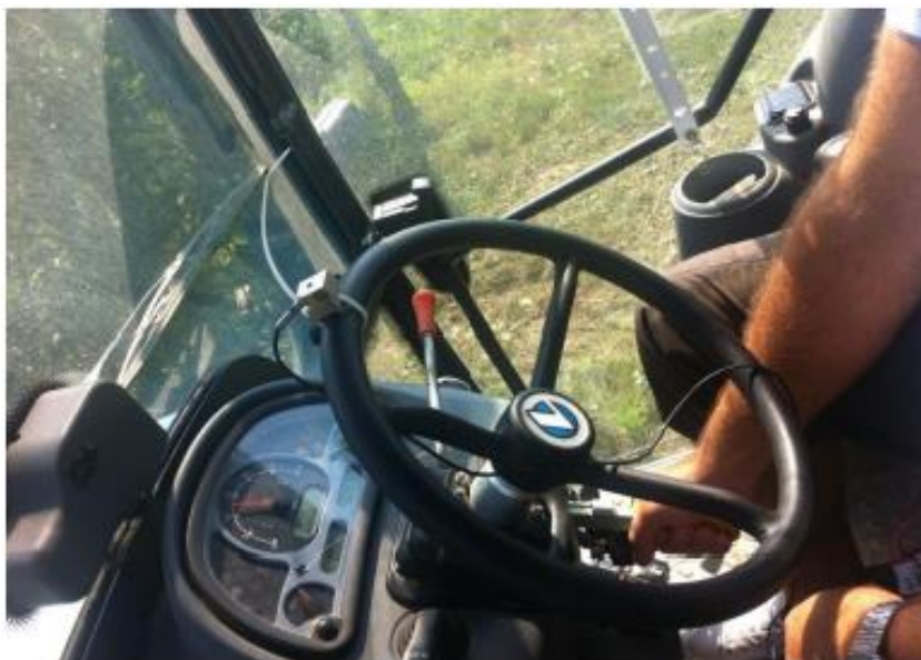
Slika 12. Položaj akcelerometra na kolu upravljača (vlastita fotografija)
