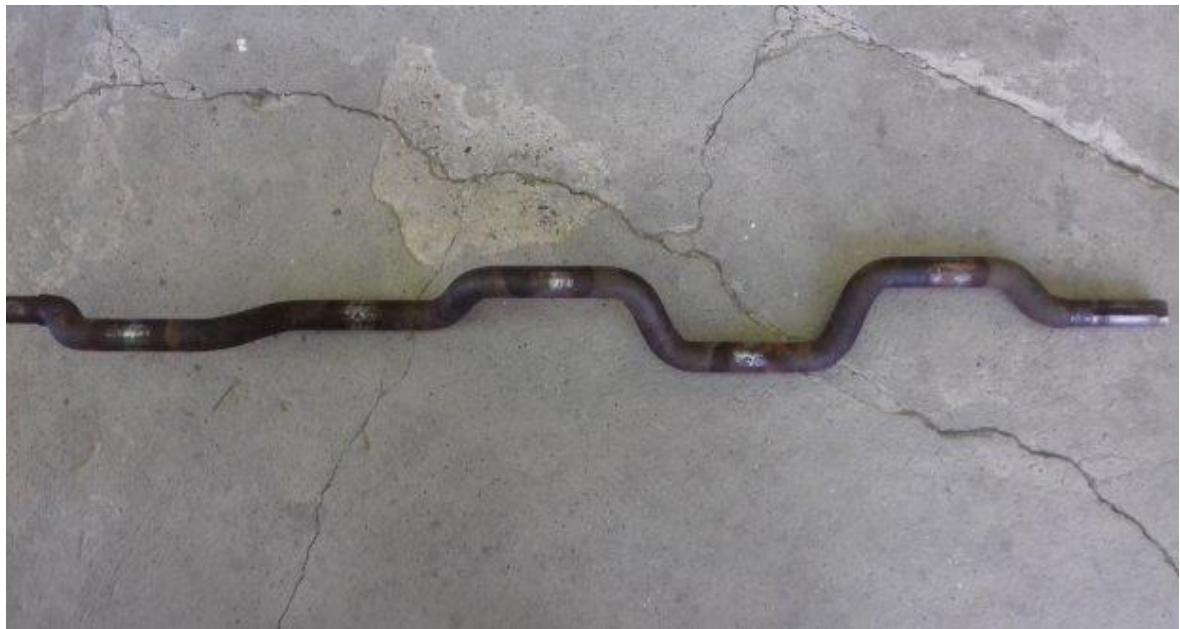
Slika 8. Prikaz koljenastog vratila slamotresa kombajna „MF Cerea 7274“
