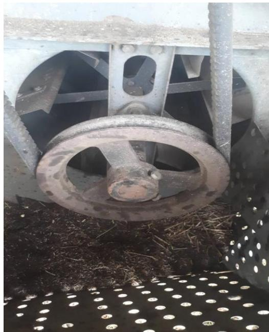
Slika 10. Prikaz pogonske remenice i remena „MF Cerea 7274“
