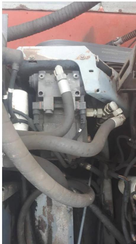
Slika 13. Prikaz pogonske hidro crpke kombajna „MF Cerea 7274“
