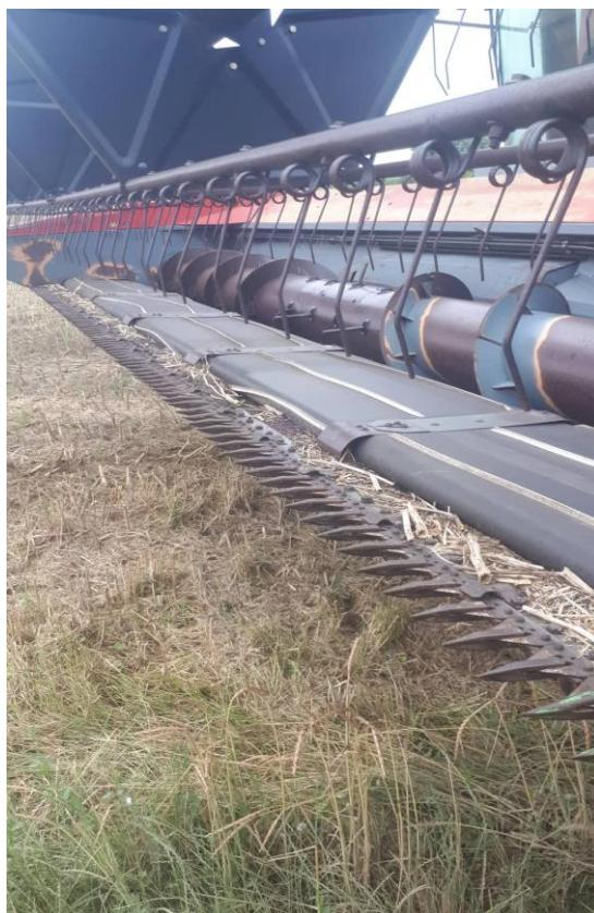
Slika 3. Prikaz žetelice kombajna s uvlačnim trakama kombajna „*MF Cerea 7274*“
