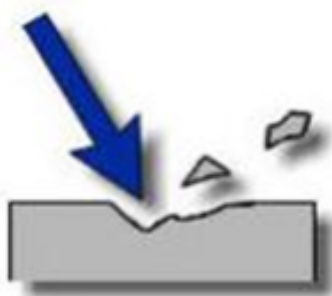
Slika 12. Erozijsko trošenje (Izvor: Žnidarec, 2009.)
