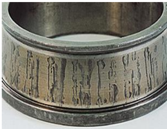
Slika 19. Primjer korozije kotrljajućeg ležaja
