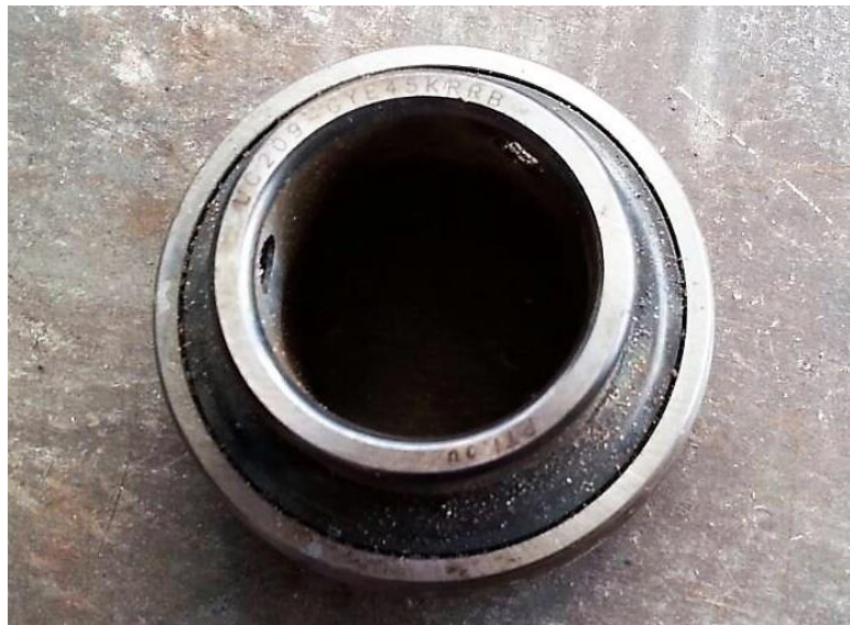
Slika 37. Očišćeni Y-ležaj trakastog transportera (Fotografija: Đurkić, 2018.)
