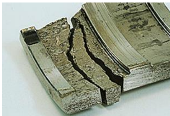
Slika 22. Primjer pukotine kotrljajućeg ležaja
