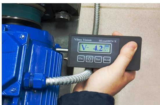
Slika 24. Mjerenje vibracija pomoću vibrometra (Izvor: http://vibrocenter.com/vibrovision_e.htm )
