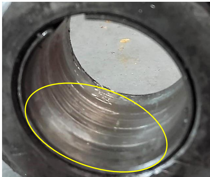
Slika 39. Abrazijsko trošenje unutarnjeg prstena ležaja (Fotografija: Đurkić, 2018.)
