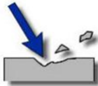
Slika 12. Erozijsko trošenje (Izvor: Žnidarec, 2009.)
