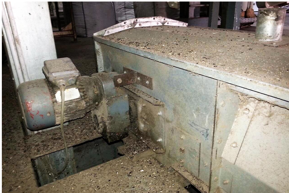
Slika 27. Pogonski motor na trakastom transporteru (Fotografija: Đurkić, 2018.)
