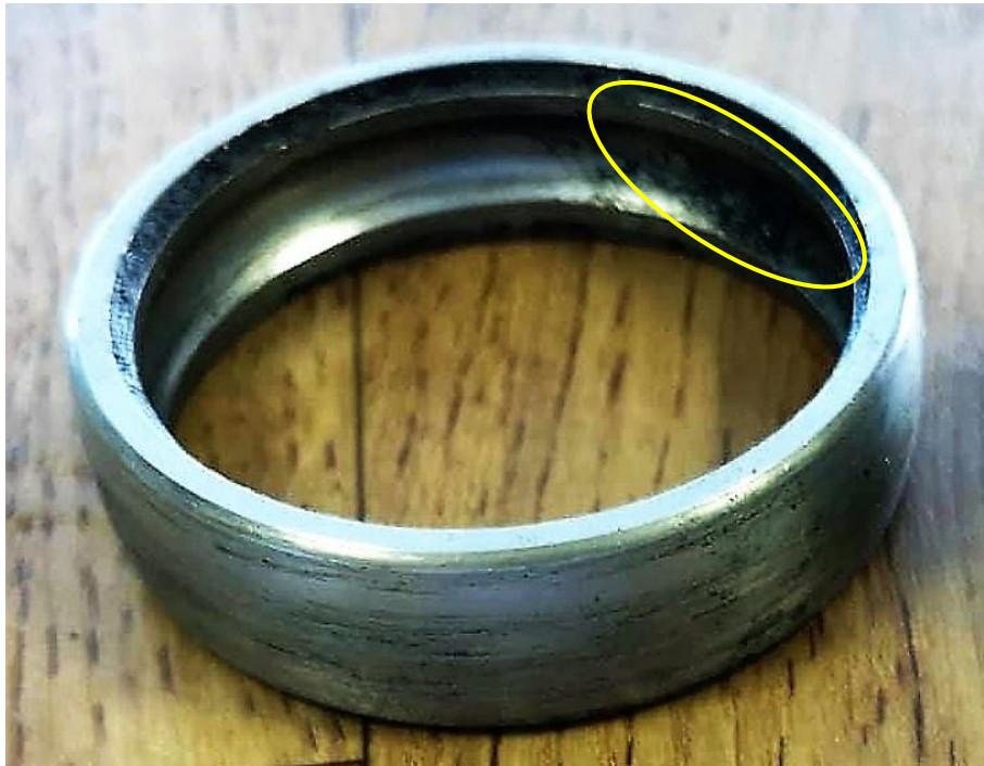
Slika 40. Zamorno trošenje vanjskog prstena ležaja (Fotografija: Đurkić, 2018.)
