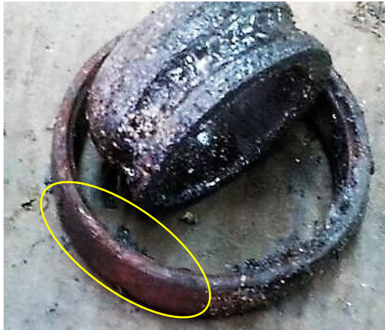
Slika 42. Korozijsko trošenje vanjskog prstena ležaja (Fotografija: Đurkić, 2018.)
