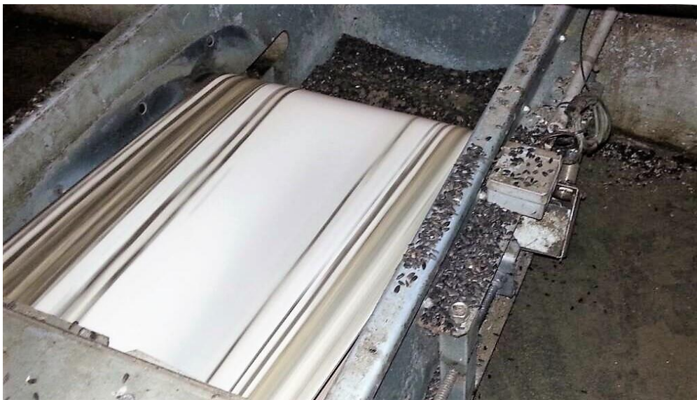
Slika 35. Trakasti transporter s rasutim sjemenom suncokreta (Fotografija: Đurkić, 2018.)
