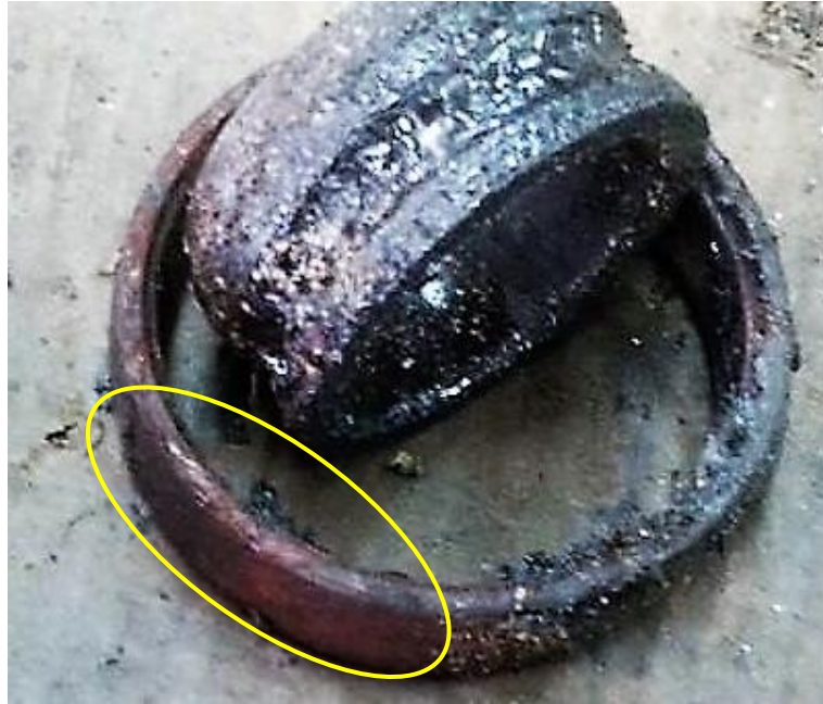
Slika 42. Korozijsko trošenje vanjskog prstena ležaja (Fotografija: Đurkić, 2018.)
