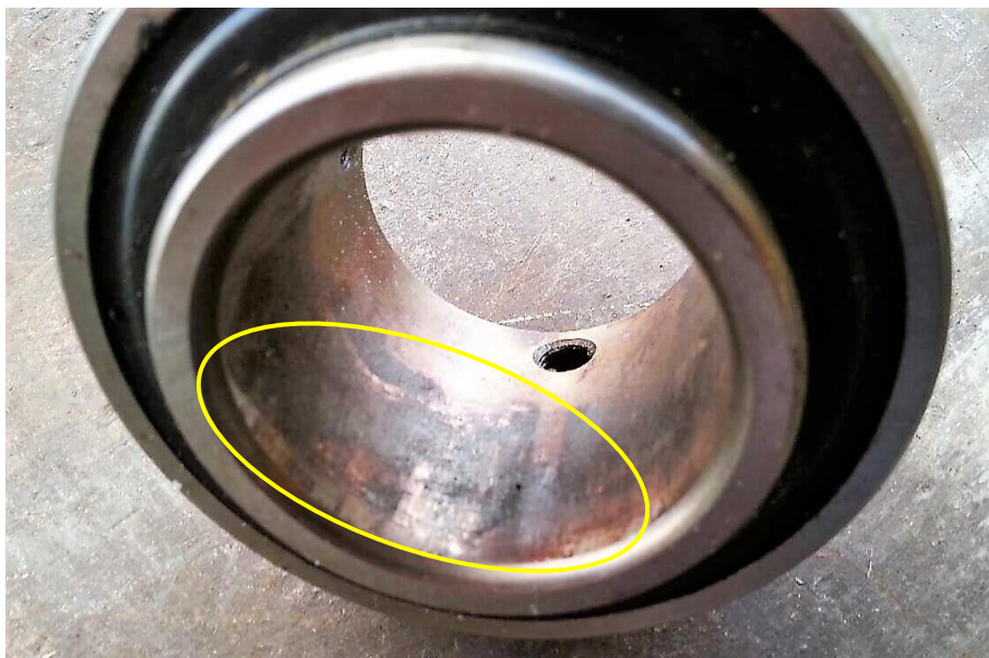
Slika 43. Korozijsko trošenje unutarnjeg prstena ležaja (Fotografija: Đurkić, 2018.)
