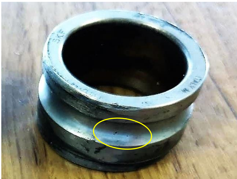
Slika 41. Zamorno trošenje unutarnjeg prstena ležaja (Fotografija: Đurkić, 2018.)
