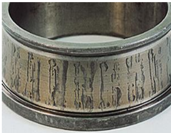
Slika 19. Primjer korozije kotrljajućeg ležaja
