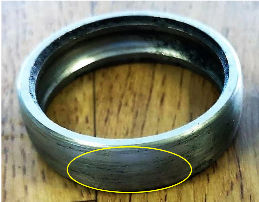
Slika 38. Abrazijsko trošenje vanjskog prstena ležaja (Fotografija: Đurkić, 2018.)
