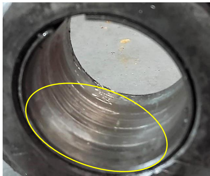
Slika 39. Abrazijsko trošenje unutarnjeg prstena ležaja (Fotografija: Đurkić, 2018.)
