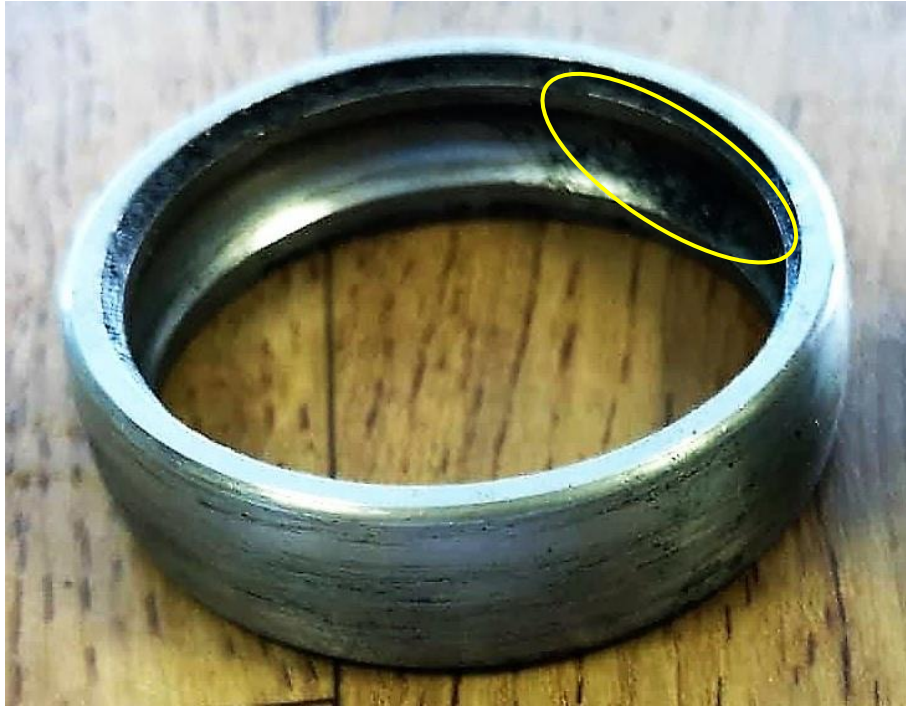
Slika 40. Zamorno trošenje vanjskog prstena ležaja (Fotografija: Đurkić, 2018.)
