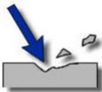
Slika 12. Erozijsko trošenje (Izvor: Žnidarec, 2009.)
