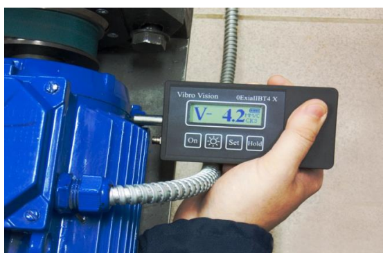
Slika 24. Mjerenje vibracija pomoću vibrometra (Izvor: http://vibrocenter.com/vibrovision_e.htm )
