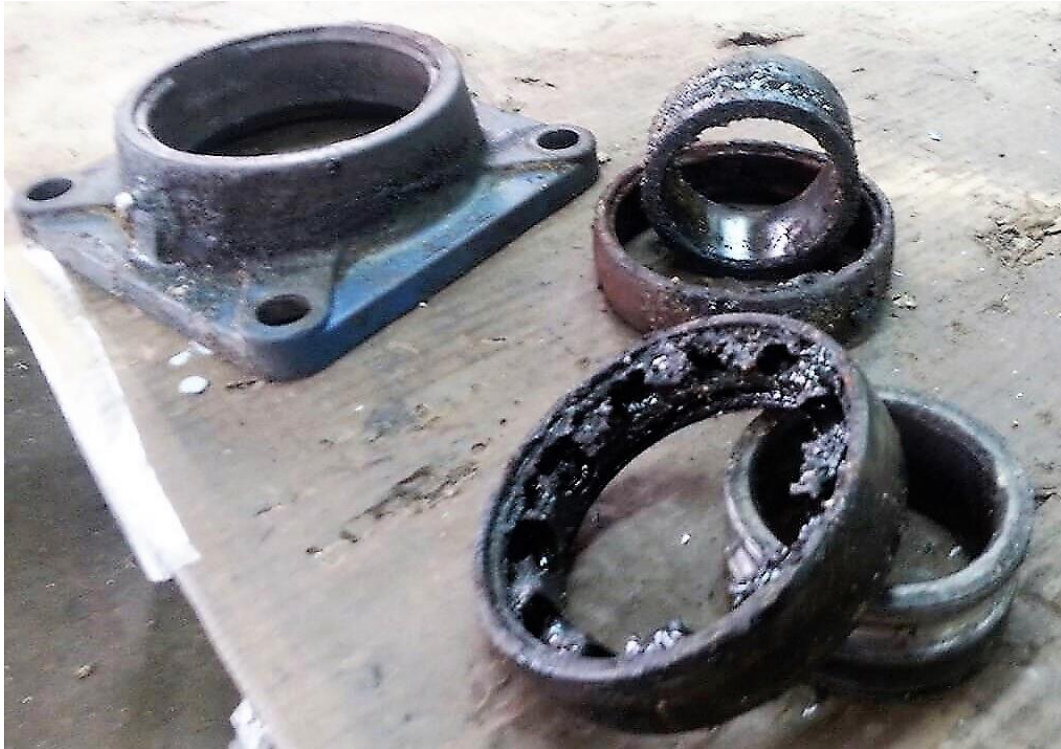
Slika 36. Demontirana jedinica s Y-ležajima (Fotografija: Đurkić, 2018.)
