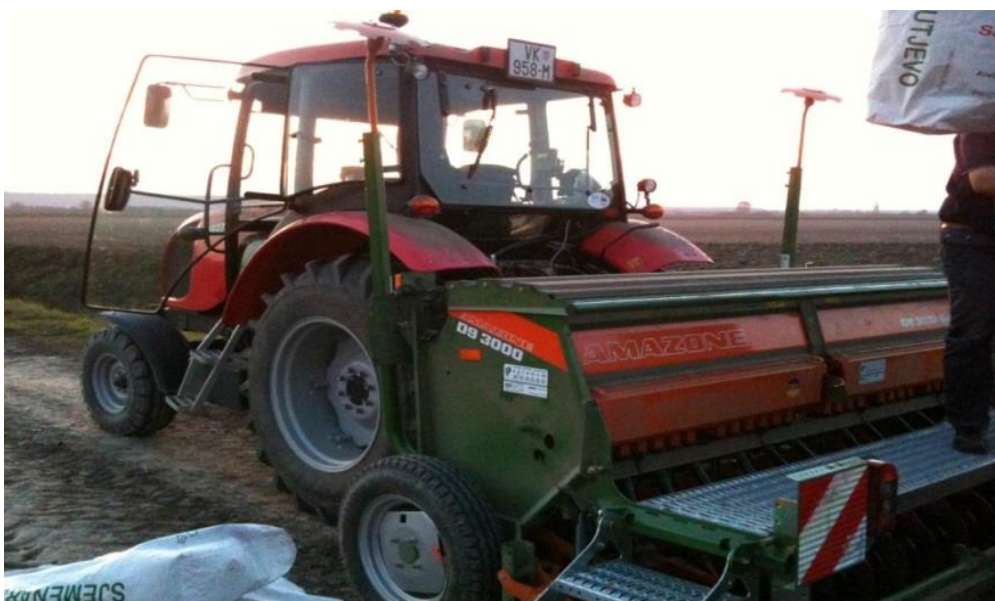
Slika 7. Sijačica Amazone D9 3000 Super (Izvor: D.-I. Pavičić)
