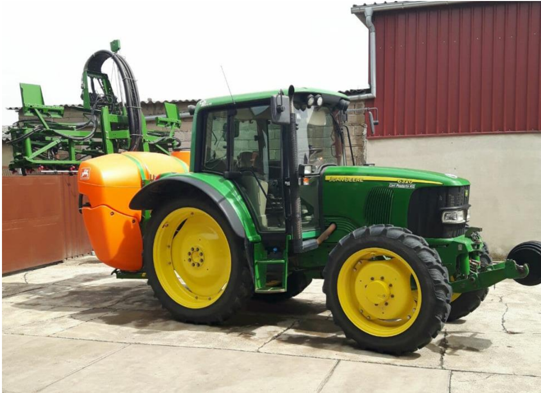
Slika 9. Prskalica Amazone UF 901 (Izvor: D.-I. Pavičić)
