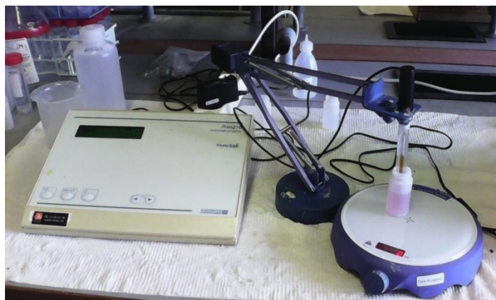
Slika 1. Mjerenje pH vrijednosti tla (Foto: Dejana Kraljević)
