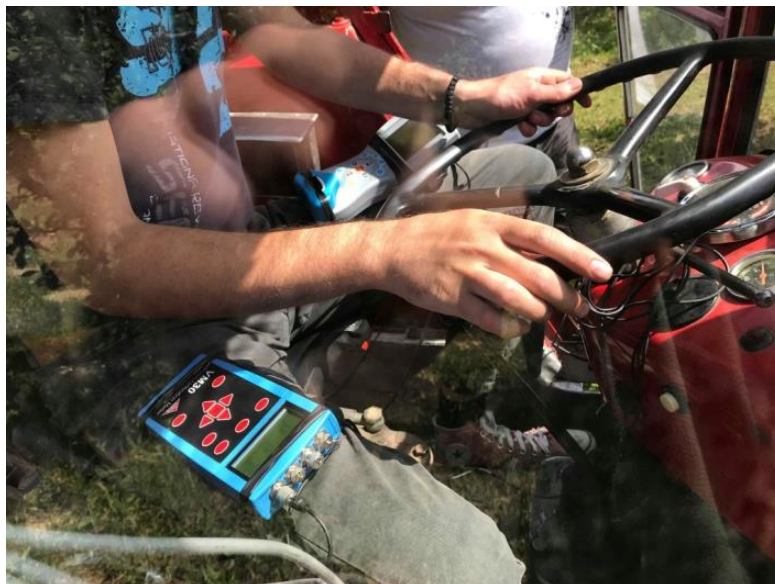
Slika 6. Mjerni uređaj MMF VM30-H
