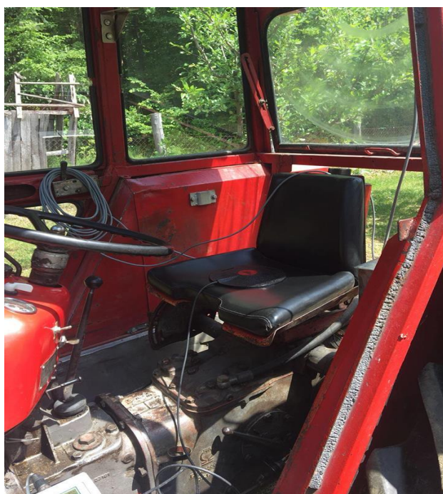
Slika 7. Položaj uređaja za mjerenje vibracija
