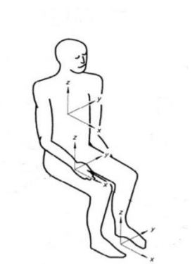
Slika 1. Položaj tijela i pravac djelovanja vibracija prilikom testiranja
