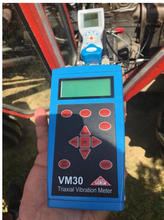
Slika 3: Uredaj za mjerenje mehaničkih vibracija MMF VM30-H
