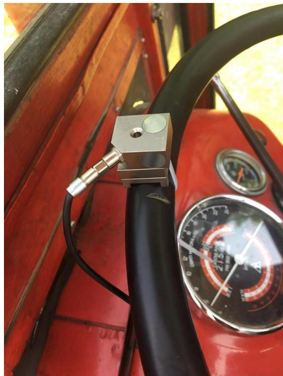
Slika 11: Senzor za vibracije
