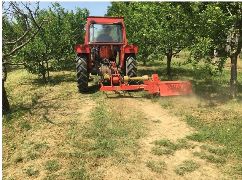
Slika 6: Bočna freza
