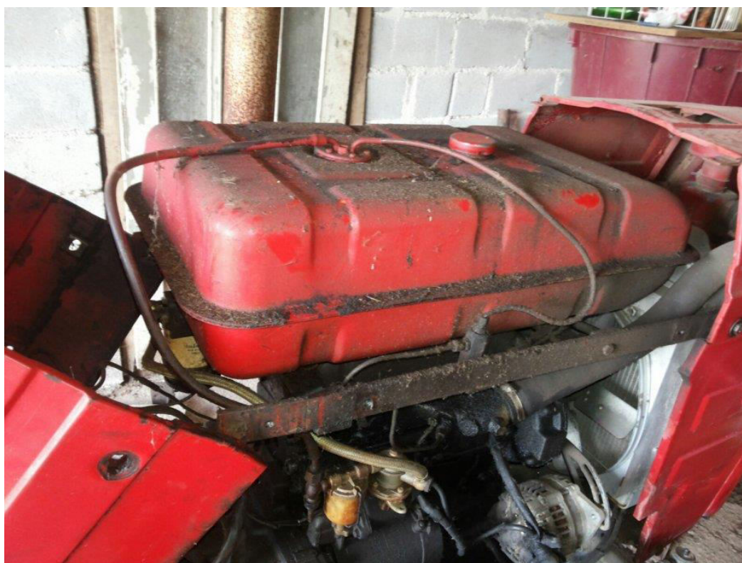
Slika 11. Metalni spremnik za gorivo na traktoru „IMT“ (Izvor: Raić D.)
