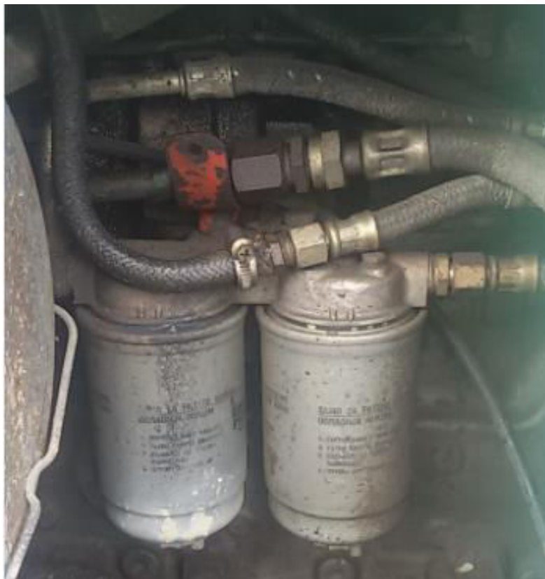
Slika 12. Grubi i fini pročištač goriva (izvor: Raić D.)
