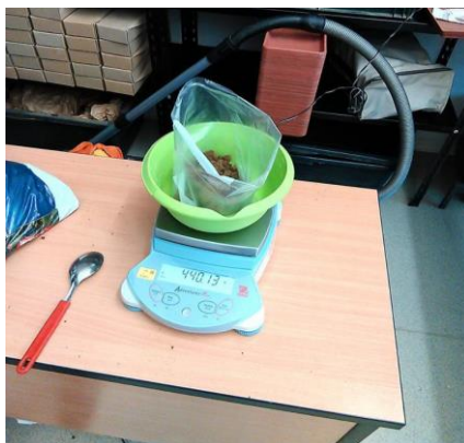
Slika 13. Vaganje uzorka prije prosijavanja (Izvor: Vlastita fotografija)
