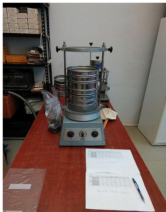
Slika 14. Električni uređaj za prosijavanje tla
