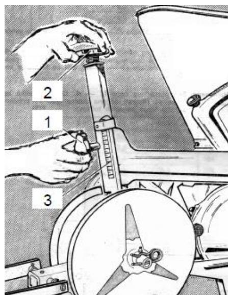
Slika 5. Podešavanje dubine sjetve kod *OLT PSK-4* sijačice
