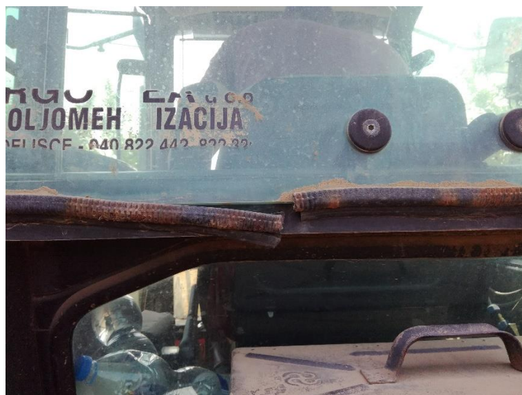
Slika 9. Puknuta guma za brtvljenje na zadnjem traktorskom staklu (Vlastiti izvor)
