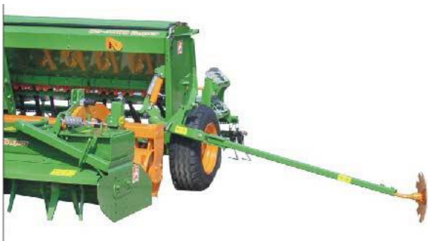
Slika 16. Marker sijačice Amazone D9 3000 Super (Izvor: Upute za uporabu AMAZONE sijačice)
