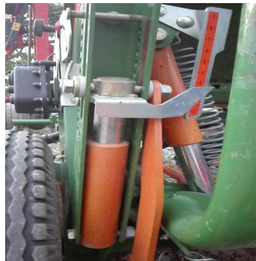
Slika 9. Hidraulični cilindar za potisak na ulagače
