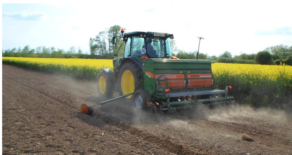
Slika 17. Traktor John Deere 6110 MC i Amazone D9 3000 Super sijačica u radu (Izvor: Vlastita fotografija)
