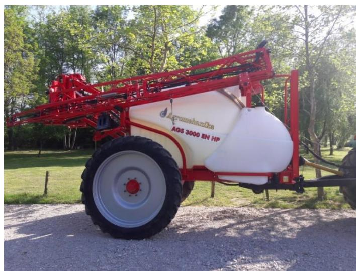
Slika 5. Ispitivana prskalica „Agromehanika AGS 3000“
