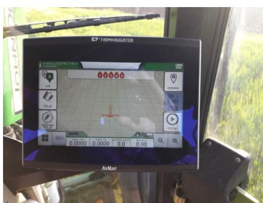
Slika 14. „AvMap“ - GPS sustav navođenja
