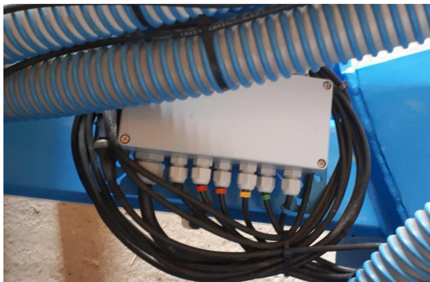
Slika 3. Elektronska kontrola sijačice (Izvor: Vlatko Gojević)
