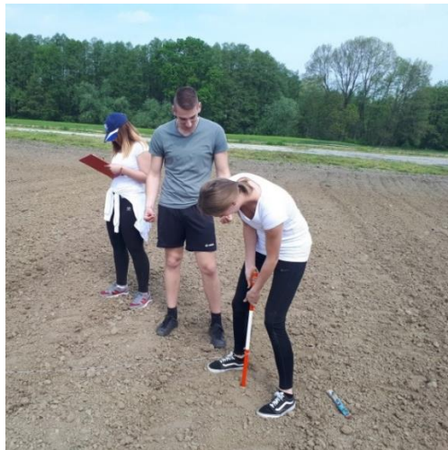
Slika 13. Postupak izrade profilograma (Izvor: Vlatko Gojević)
