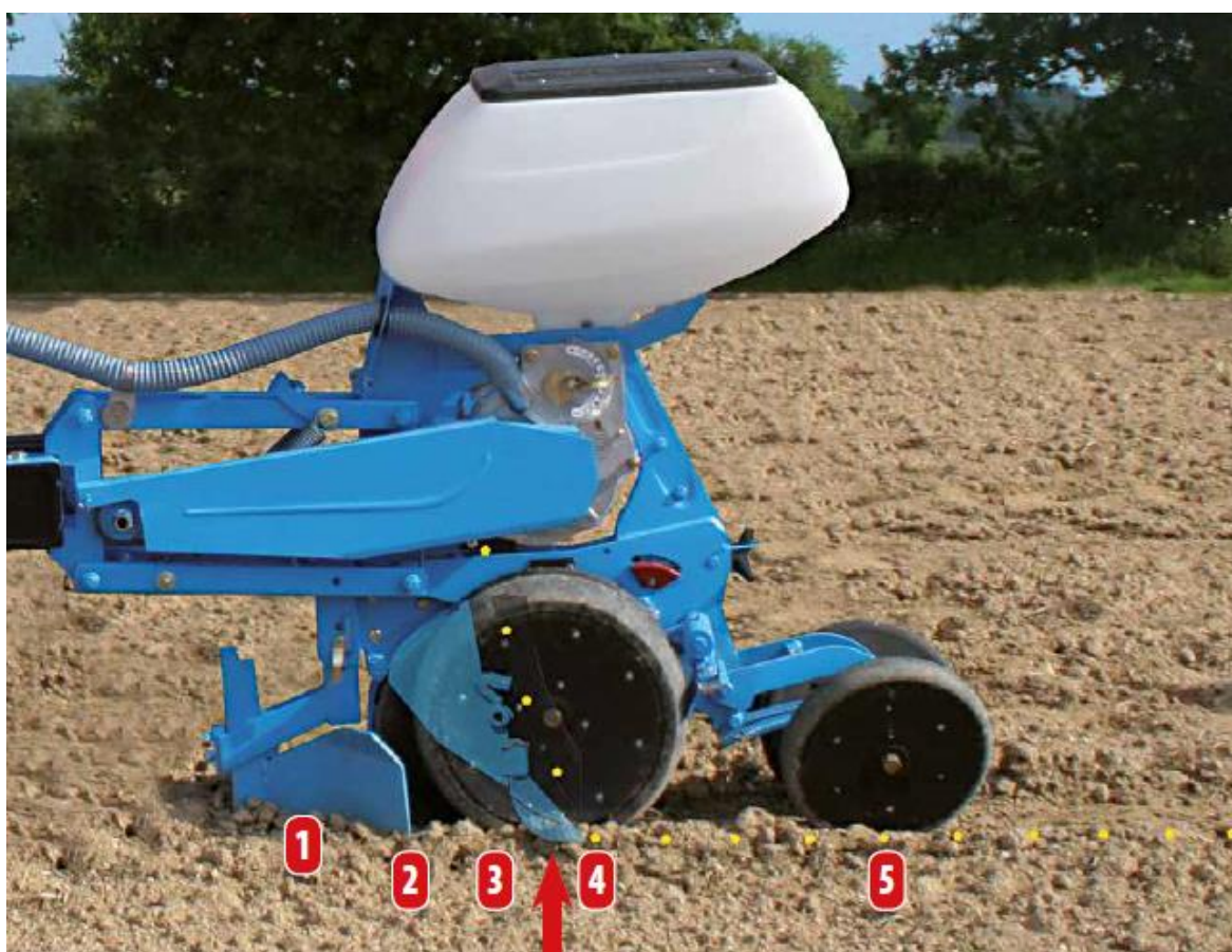
Slika 4. Bokocrt sjetvenog aparata (Izvor: Uputstvo sijačice Monosem)
