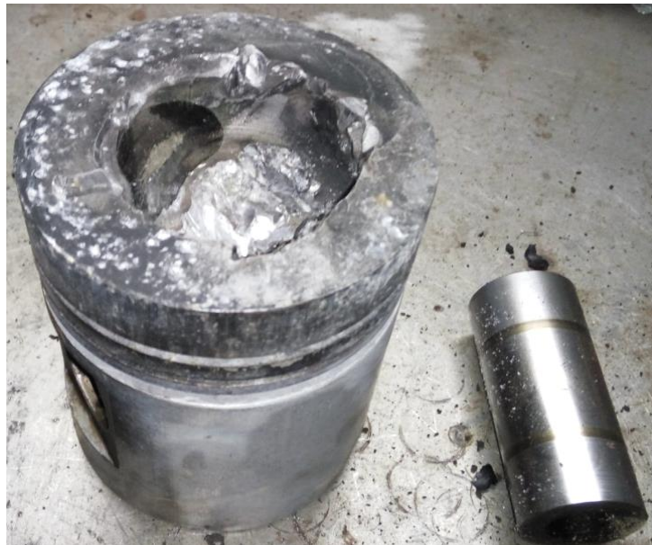
Slika 20. Oštećen klip i osovinica klipa (izvor: autor)
