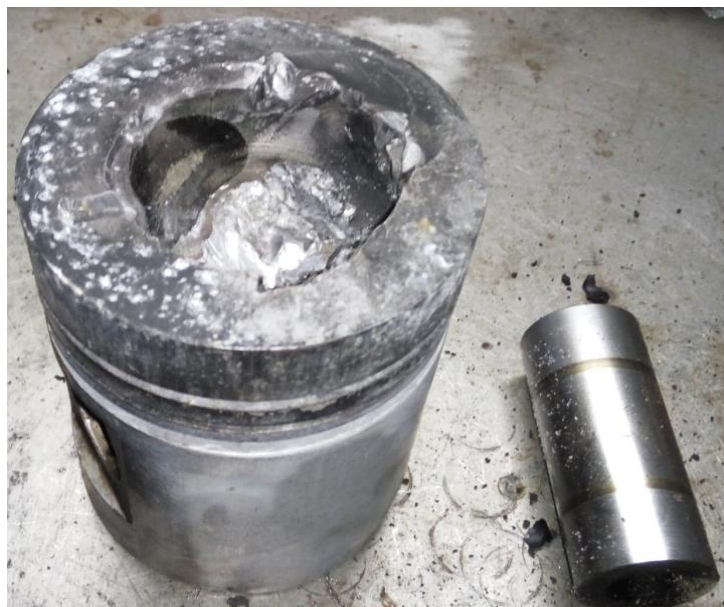
Slika 20. Oštećen klip i osovinica klipa (izvor: autor)
