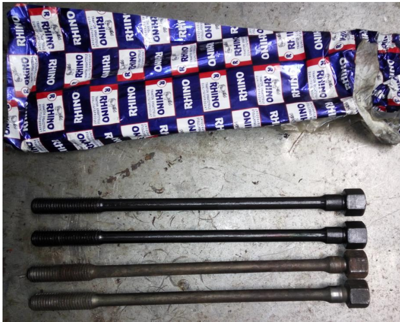
Slika 17. Elastični vijci cilindarske glave (izvor: autor)
