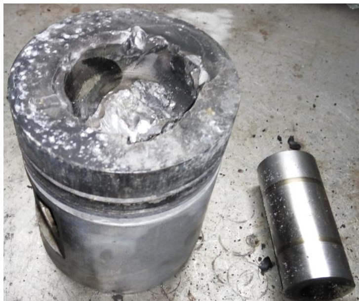
Slika 20. Oštećen klip i osovinica klipa (izvor: autor)
