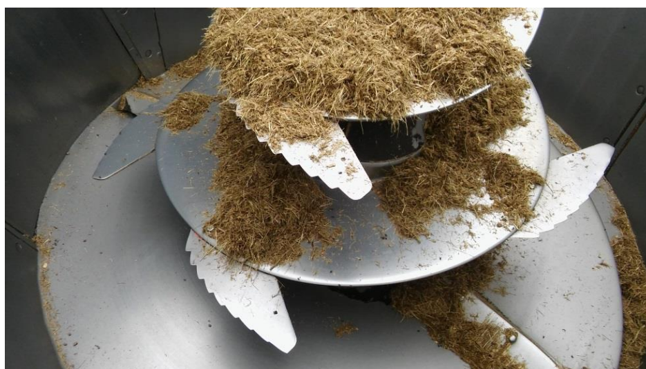
Slika 12. Noževi za mješanje hrane u mješalici za stočnu hranu (Izvor: Vincetić I.)
