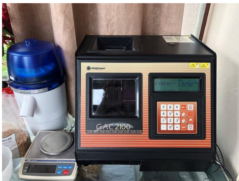
Slika 2. Uređaj za određivanje vlage zrna i hektolitarske mase i precizna digitalna vaga AND EK-610i (Izvor: Pušelja, N.)
