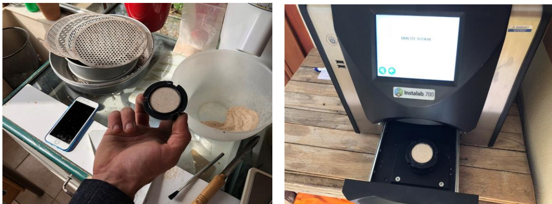
Slika 6 a i b. Utvrđivanje sadržaja proteina u zrnu pšenice (Izvor: Pušelja, N.)
