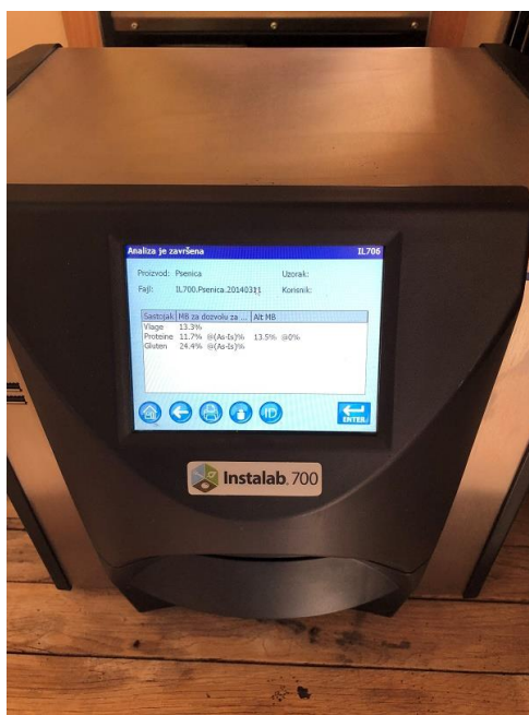
Slika 7. Prikaz zaslona sa određenim sadržajem proteina i glutena (Izvor: Pušelja, N.)
