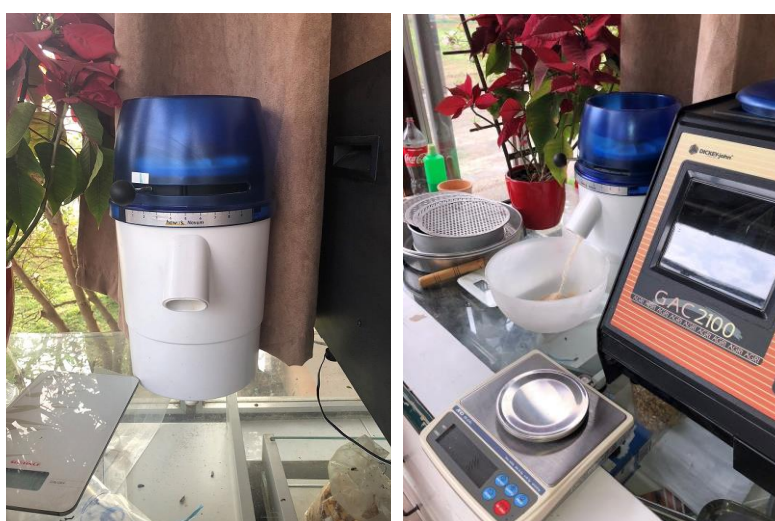
Slika 4 a i b. Uređaj za mljevenje zrna žitarica i postupak mljevenja zrna (Izvor: Pušelja, N.)
