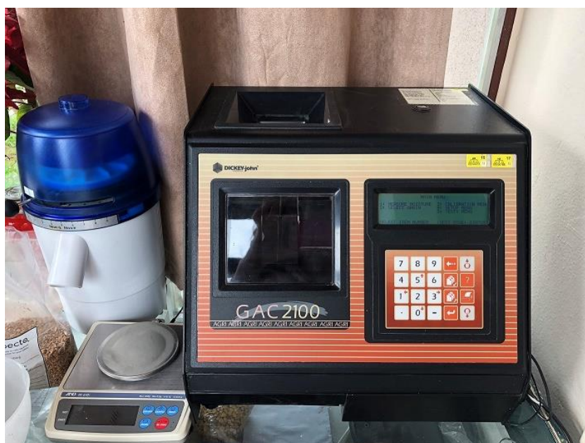
Slika 2. Uređaj za određivanje vlage zrna i hektolitarske mase i precizna digitalna vaga AND EK-610i (Izvor: Pušelja, N.)
