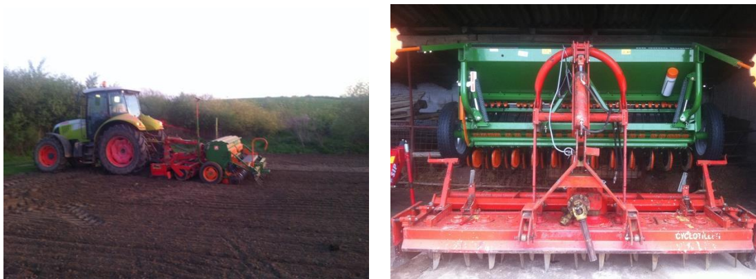
Slika 9 a i b. Rotodrljača u kombinaciji sa sijačicom Amazone D9 (Izvor: Pušelja, N.)
