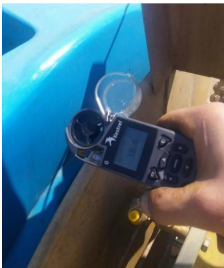
Slika 14. Mjerenje brzine zraka anemometrom Kestrel 4500 BT Autor: D. Petrović
