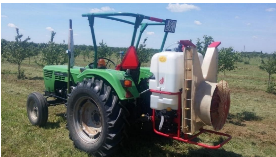
Slika 8. Nošeni raspršivač Agromehanika ENU 200
