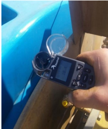
Slika 14. Mjerenje brzine zraka anemometrom Kestrel 4500 BT Autor: D. Petrović
