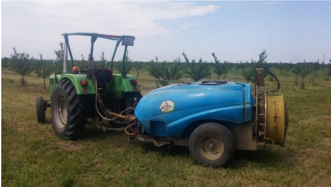
Slika 9. Vučeni raspršivač Tifone Vento 1500
