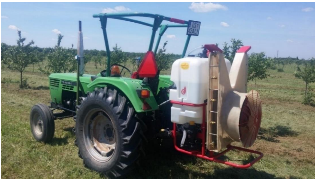
Slika 8. Nošeni raspršivač Agromehanika ENU 200
