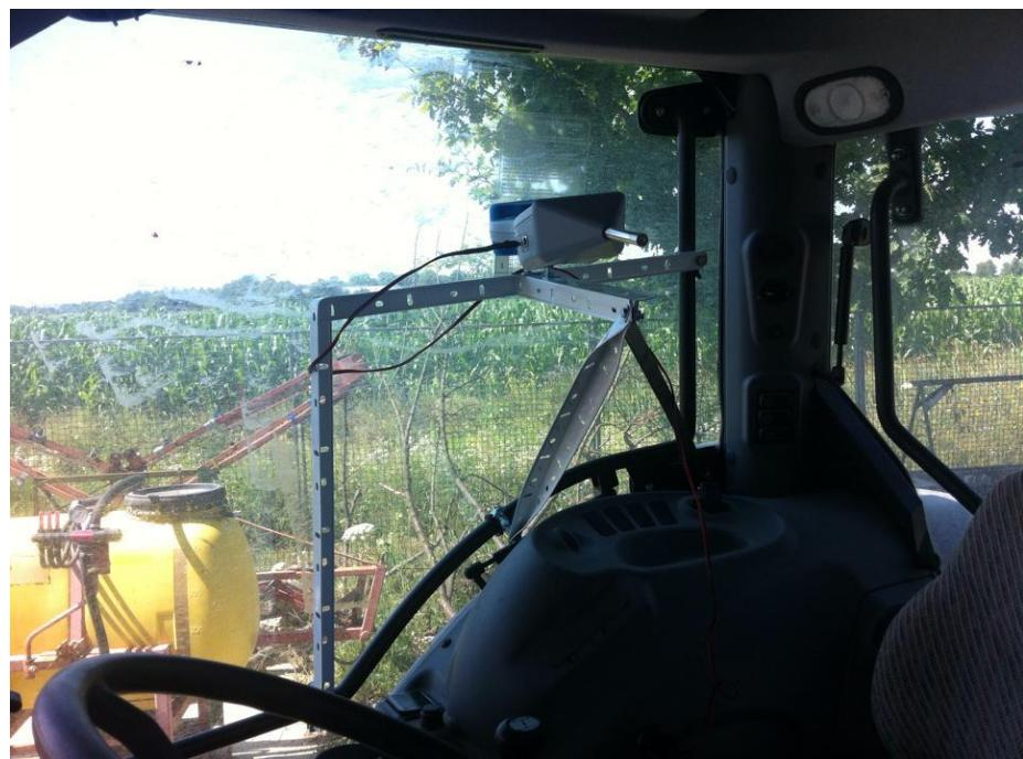
Slika 3. Postavljanje uređaja za mjerjenje buke (vlastita fotografija)
