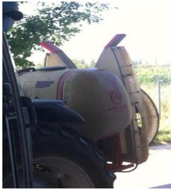
Slika 7. Nošeni traktorski atomizer Agromehanika AGP 250 (vlastita fotografija)
