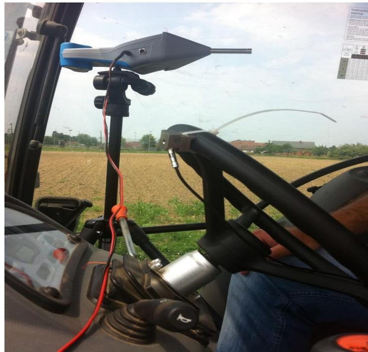
Slika 6. Uređajem za mjerjenje buke proizvođača METREL tipa Multinorm MI 6201 EU
