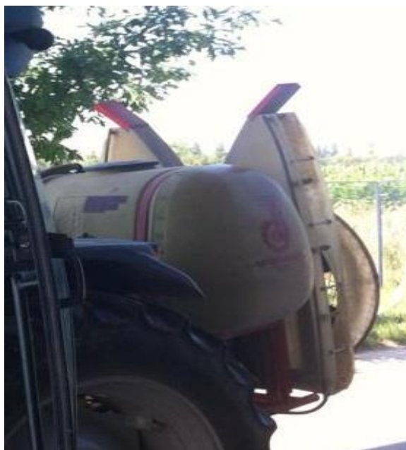
Slika 7. Nošeni traktorski atomizer Agromehanika AGP 250 (vlastita fotografija)
