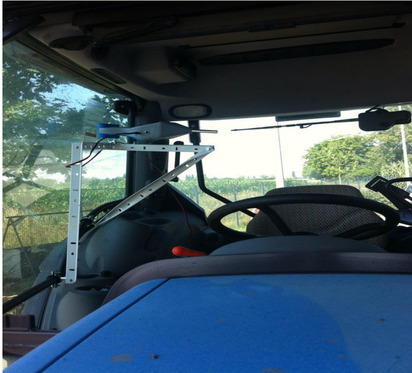
Slika 2. Postavljanje uređaja sa desne strane rukovatelja traktora (vlastita fotografija)
