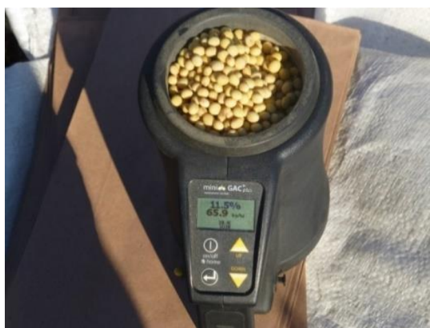
Slika 11. Mjerenje vlage i hektolitarske mase uređajem Dickey John (foto original; D. Galić Subašić)
