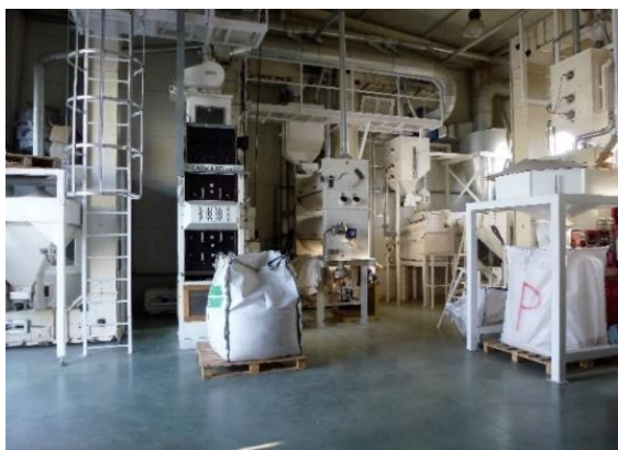
Slika 14. Usipni koš i selektor (foto original; D. Galić Subašić)
