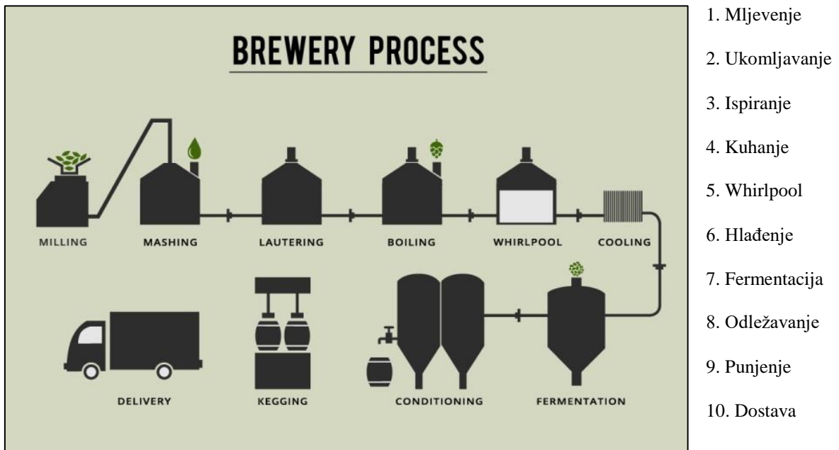
Slika 5. Proces proizvodnje piva
