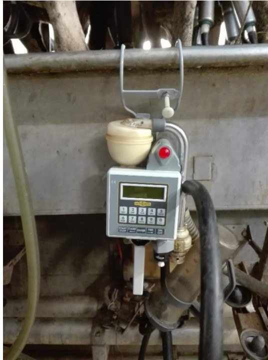
Slika 13. Lactocorder postavljen na muzno mjesto u izmuzištu (T. Bobić)
